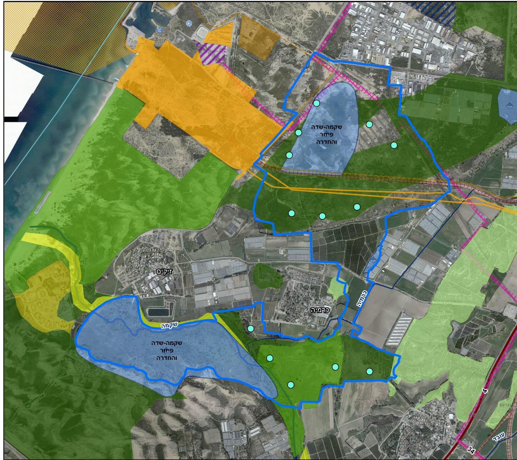
מפה 32: תמ"א אחת - תשריט ראשי: שטחים מוגנים ותשתיות. בפולגון כלולים שני שטחים מוגנים, וכן חוצה אותו מסדרון תשתיות הכולל קו חשמל ארצי מאושר, מסילת רכבת ותוואי גז טבעי ארצי.
